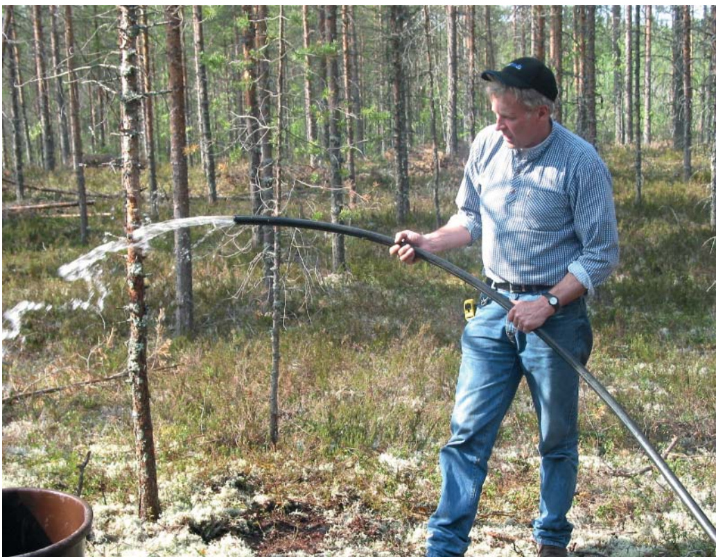
Pohjaveden pumppausputkea huuhdellaan. Putkea pitelee Hannu Kähkölä.
