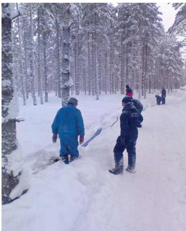
Vartinvaaran koepumppausta aloitellaan. Koepumpattu vesi juoksee muovisukkaa pitkin, sukkaa metsään juoksuttamassa Matti Honkamaa, Seppo Rantoharju, Hannu Kähkölä ja Aarne Miettunen.
