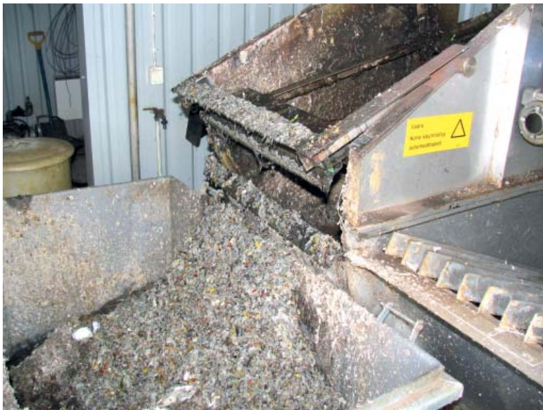
Jätevesipuhdistamon kuivaa tuotetta.
