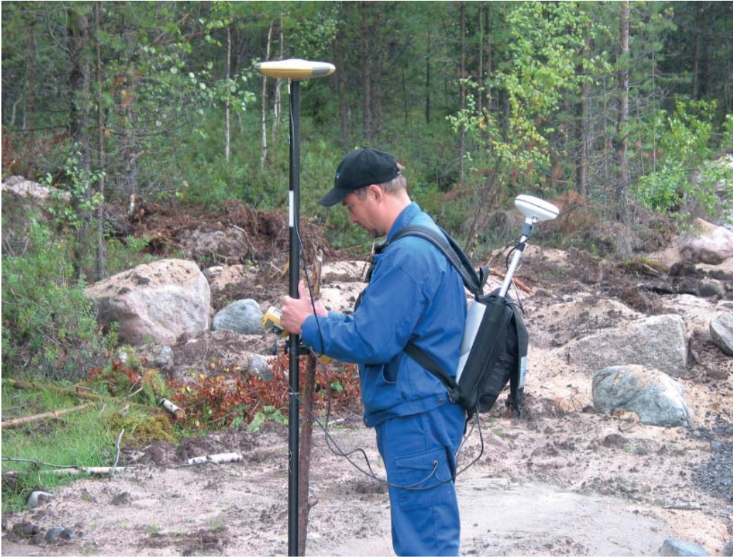
Timo Haapala kartoittamassa rakennettua vesijohtoverkosta.
