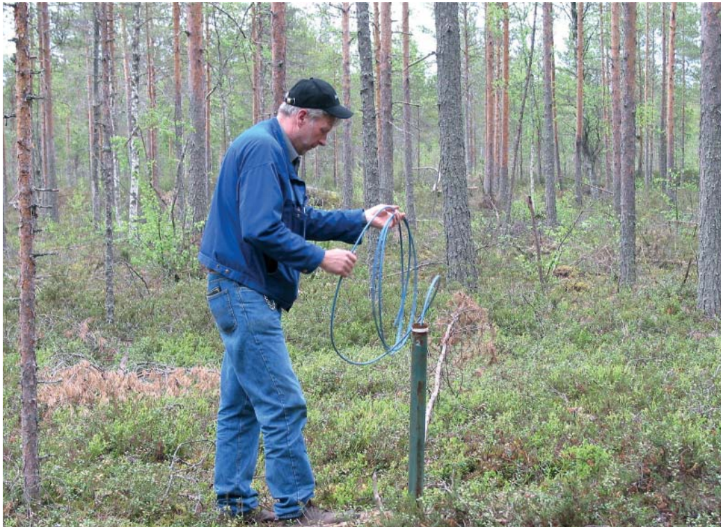
Hannu Kähkölä mittaamassa pohjaveden pintaa Koivula 1 -alueella. Mittauskierroksella käydään joka kuukauden ensimmäinen maanantai.
